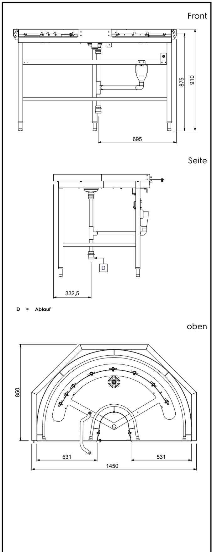
Handlingsystem für Korbtransportmaschinen
